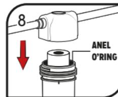
Observe se o anel O'ring utilizado para a vedação do filtro está devidamente alojado no copo e ajuste o refil interno, encaixando-o no copo como indicado na figura.
