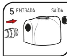
Usando cola para canos, cole um adaptador compatível com a rosca de 3/4" no encanamento, verifique as indicações de ENTRADA e SAÍDA.
