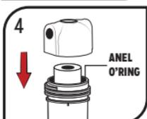
4 Observe se o anel O'Ring (preto) está devidamente acoplado ao copo, verifique para que o refil esteja bem posicionado para evitar vazamentos após o aperto do copo. Encaixe o copo na tampa e rosqueie.
