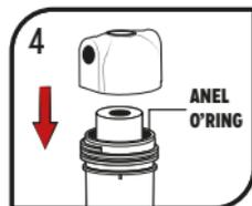
4 Observe se o anel O'Ring (Preto) de vedação está devidamente acoplado ao copo e verifique para que o refil esteja bem posicionado e encaixado. Encaixe o copo na tampa e rosqueie.
